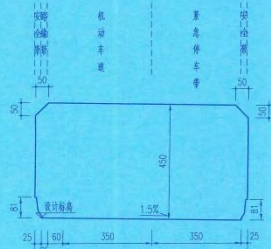
隧道主线建筑限界图(四) 加宽段 1:100
