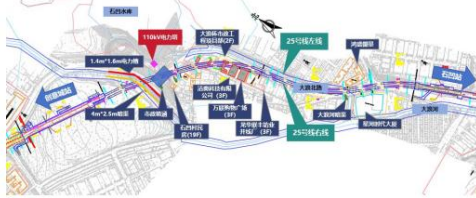
图 1.2-2 深圳市城市轨道交通 25 号线一期工程创世纪站-石凹站区间总平面图
