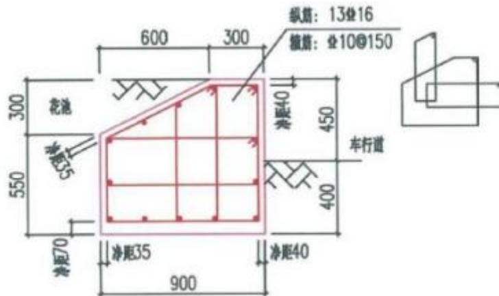
渠化岛花池侧墙结构大样图
