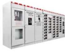
GCK(L)型低压抽出式开关柜 适用于发电厂、冶金轧钢、石油化工、轻工纺织、港口码头、大楼宾馆场所作 最大工作电压到660V 最大工作电流至3150A 馈线及母线额定电流至4000A
