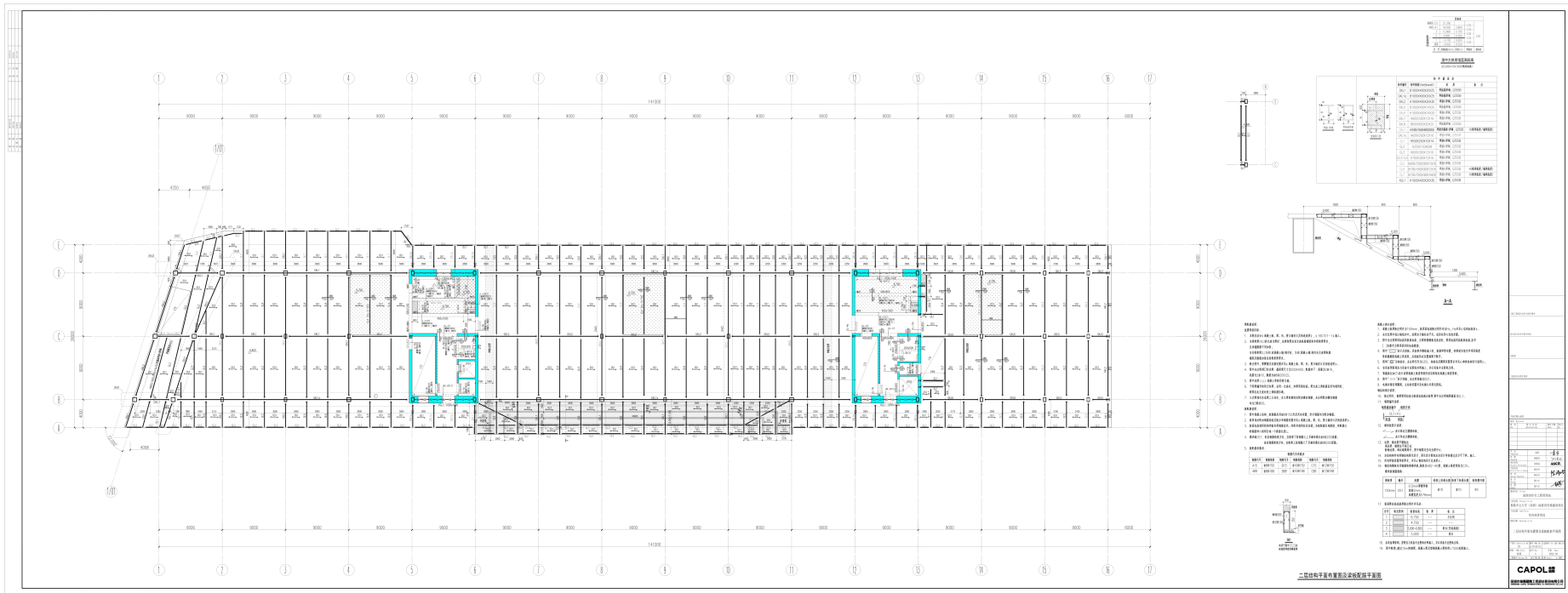
钢结构图纸—钢结构跨度 54m (9m*6)
