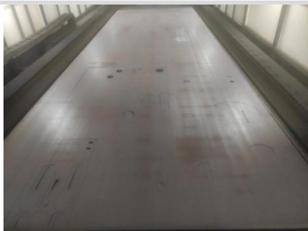
油箱箱盖激光割一次成型
