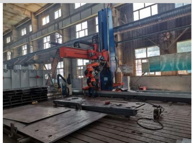
CL00S 焊接机器人
