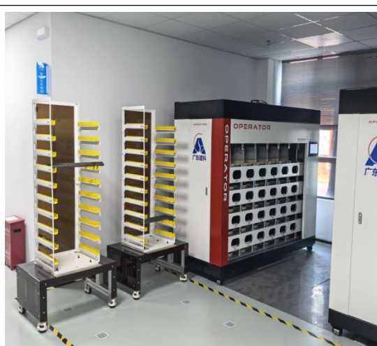
钢筋检测前期自动化收样系统及混凝土抗渗智能检测系统（深圳实验室）
