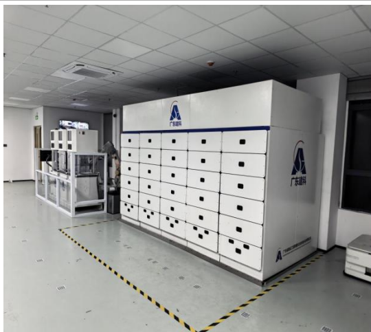
混凝土抗压强度智能检测系统及混凝土智慧养护柜（深圳实验室）
