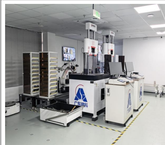
智能钢筋性能检测系统（深圳实验室）
