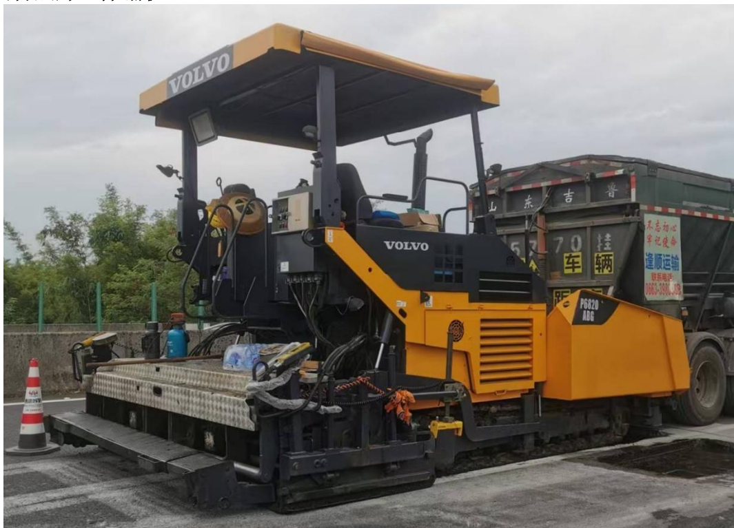
设备照片(摊铺机)
