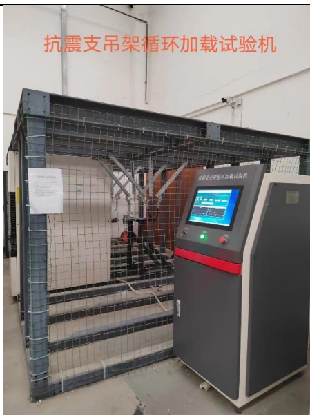
抗震支吊架循环加载试验机
