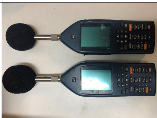
双通道建筑声学测试系统
