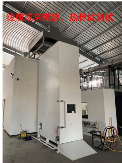
电线电缆热释放试验装置
