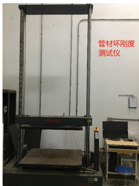
管材环刚度测试仪
