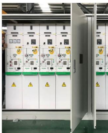
生产户外开闭所
