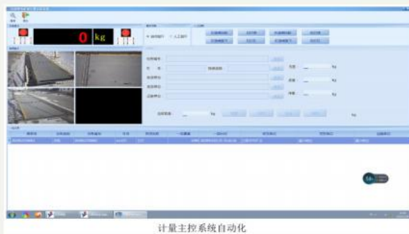
地勘集团地磅升级改造项目——汽车衡无人值守
