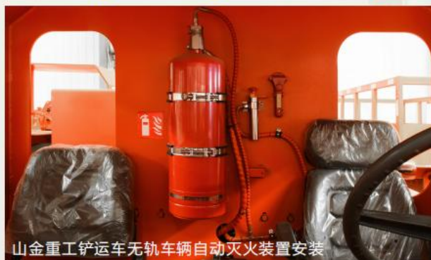
玲珑金矿机修中心立方矿运机无轨车辆自动灭火装置安装
