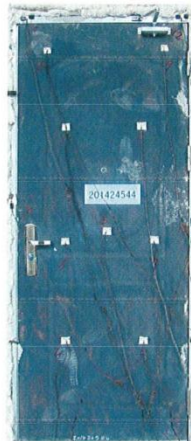
照片 1 耐火性能试验前试件情况
