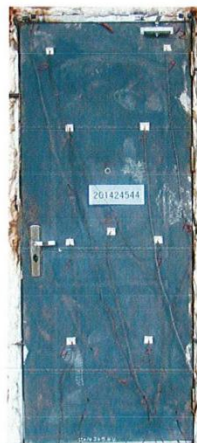
照片 2 耐火性能试验结束时试件情况
