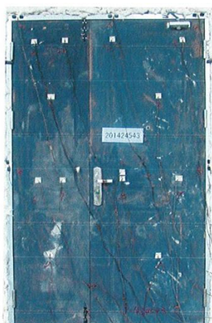
照片 1 耐火性能试验前试件情况
