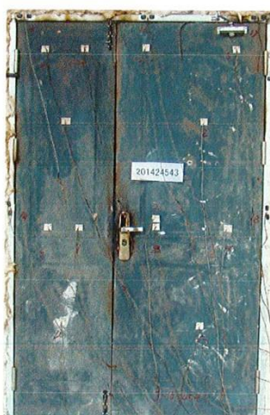
照片 2 耐火性能试验结束时试件情况
