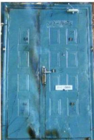
照片 2 耐火试验结束时试件情况
