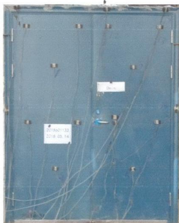
照片 1 耐火性能试验前试件情况
