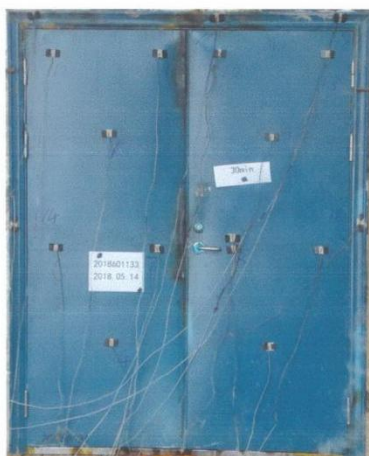
照片 2 耐火性能试验结束时试件情况
