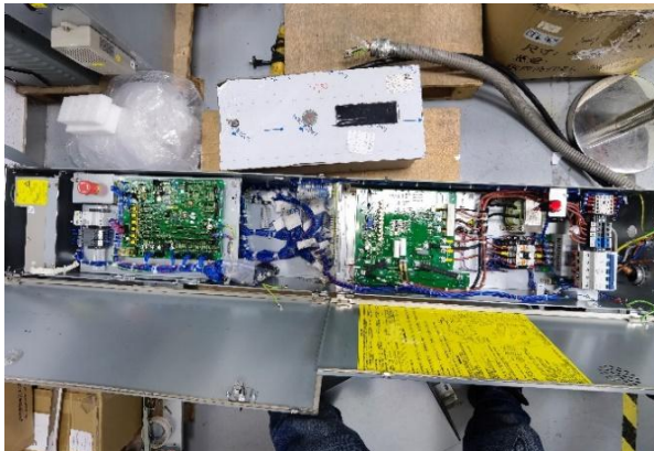
图 15 控制柜内走线
