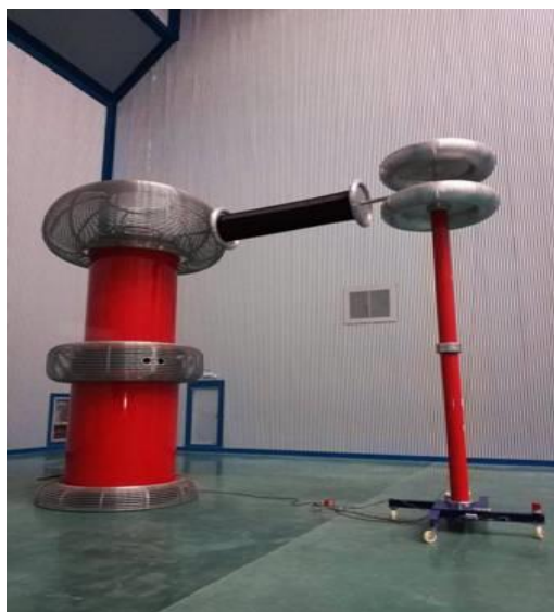
工频试验变压器
