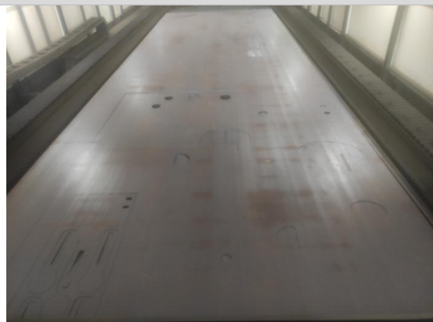
油箱箱盖激光割一次成型
