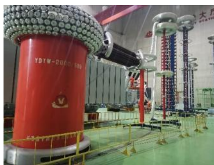
工频耐压 试验成套装置
