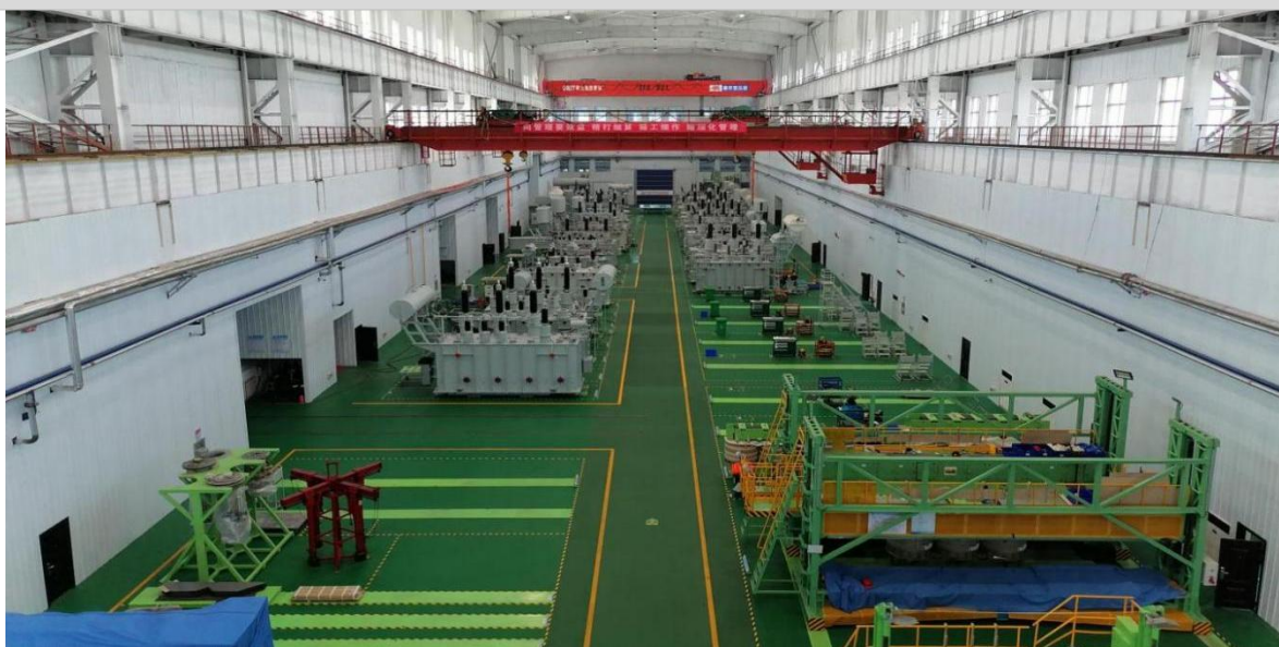
● 110kV 变压器装配区
