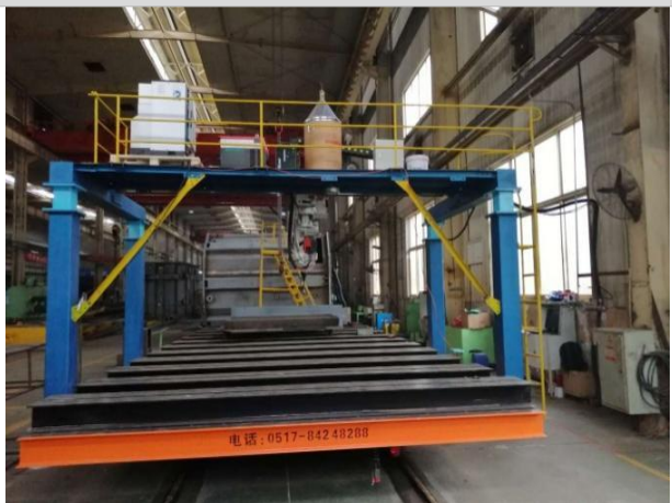
激光跟踪焊接机器人
