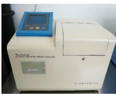
绝缘油介损测试仪
