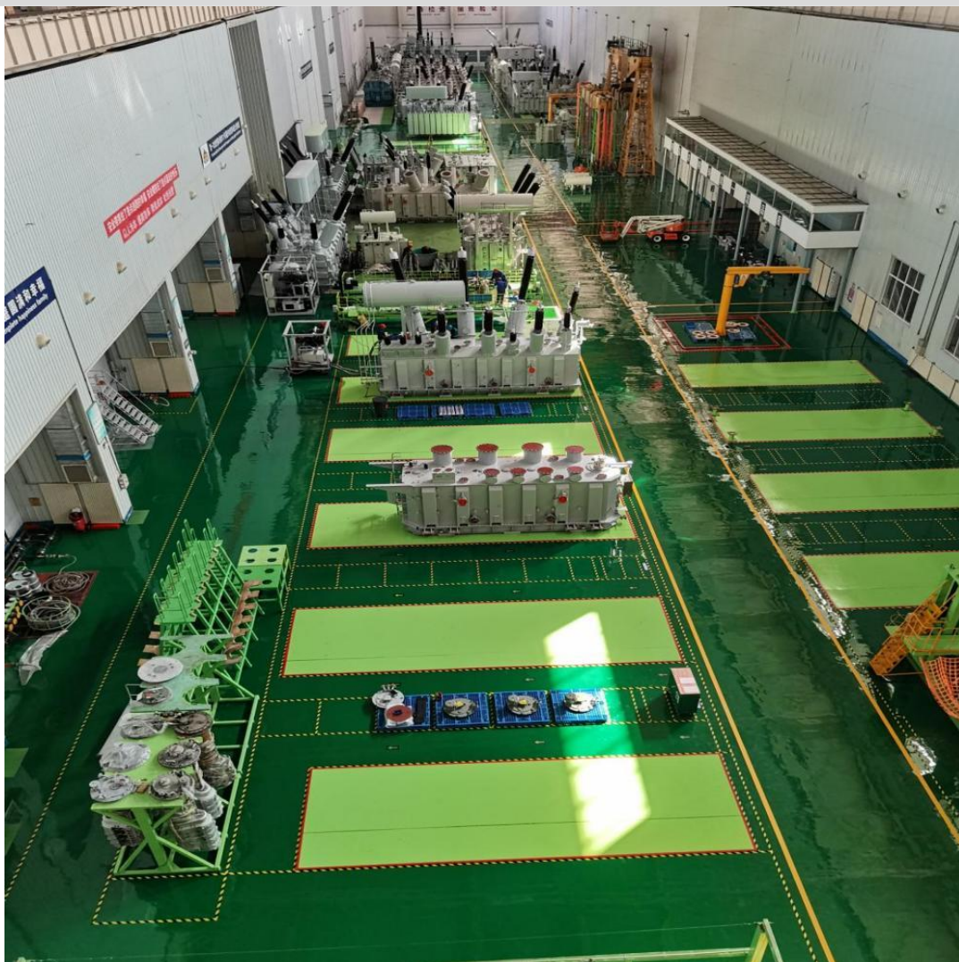
● 220kV-1000kV 变压器装配区
