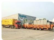
中国第一台三卷移动变 20MVA-110/35/10.5kV 宁夏银川
