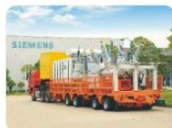
中国第一台110kV移动变 20MVA-110/10.5kV 四川德阳
