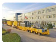
中国第一台110kV植物油移动变 40MVA-110/10.5kV 河南新乡
