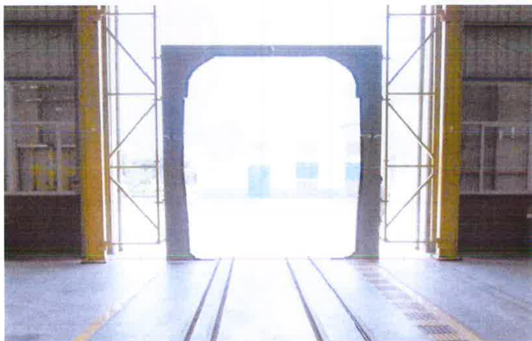
机车车辆限界检测装置
