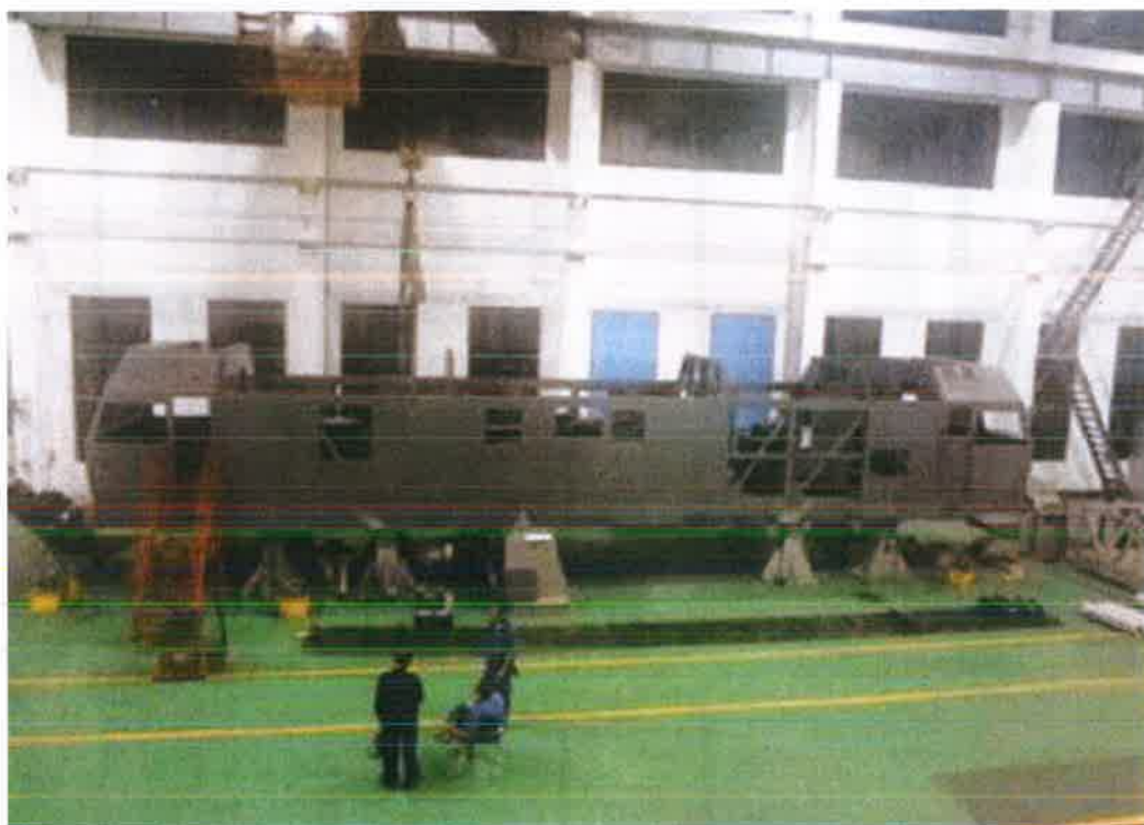
车架静强度试验
