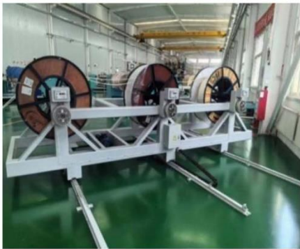
新三轴换位导线放线架使用效果图
