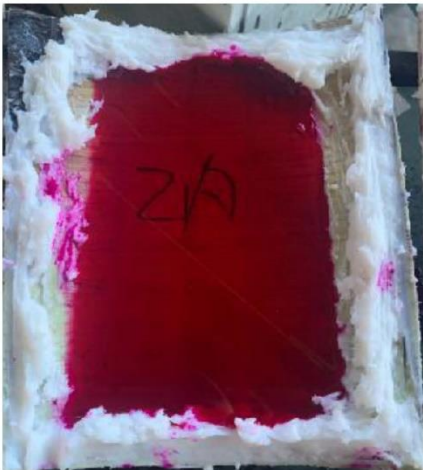
拆解密封性试验
