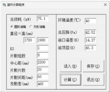
图 4 自研的温升计算程序，选取最优散热中心
