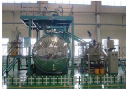
(9) 气相干燥罐：世界先进的电抗器器身干燥设备，利用溶剂在真空状态下加热蒸发实现对产品的加热，热传导效率高，干燥彻底，同时冷凝液可对产品进行冲洗，提高器身清洁度。提高产品产品的介损、局放等性能参数。
