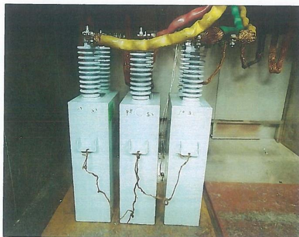
照片 Photograph 9 热稳定性试验 thermal stability test
