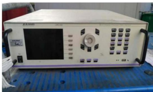
c) 损耗测量：采用纯进口功率分析仪，对产品损耗、电压电流、电抗值进行测量，数据准确可靠。
