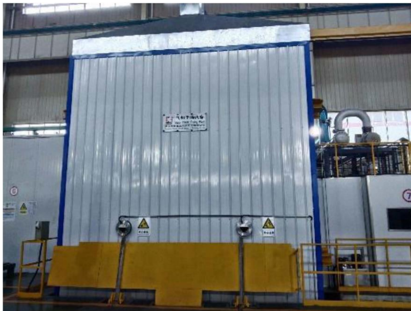
(10) 真空滤油机：行业领先的真空注油设备，设备极限真空度达到 5Pa 以下，采用三级过滤，过滤精度微米级，有效保证产品局放性能。同时变压器油耐压、微水、介损、色谱等指标均远优于国标水平。
