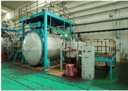
(9) 气相干燥罐：世界先进的电抗器器身干燥设备，利用溶剂在真空状态下加热蒸发实现对产品的加热，热传导效率高，干燥彻底，同时冷凝液可对产品进行冲洗，提高器身清洁度。提高产品产品的介损、局放等性能参数。
