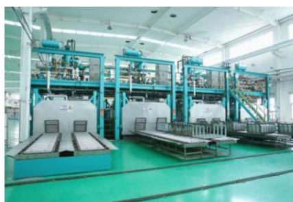
环保型电容器真空浸渍系统
