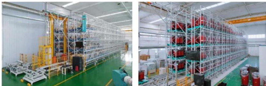
（4）总装及试验工序“岛式和流水作业”相结合的柔性精益装配线
