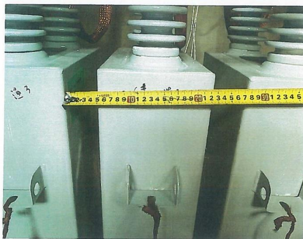
照片 Photograph 8 热稳定性试验 thermal stability test
