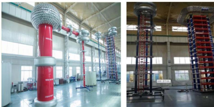
b) 局放试验：局放设备采用国内先进的多通道数字式局放测试仪，局放试验在屏蔽室内进行，背景局放值 <1\text{pc} ，可以有效消除空间干扰、地干扰和电源干扰，准确测量产品的实际局放数值。
